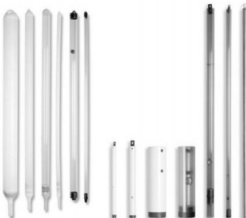
รูปที่ 17 ตัวอย่างเบลเลอร์ในการเก็บตัวอย่างน้ำใต้ดินที่ทำจากวัสดุแบบต่างๆ
