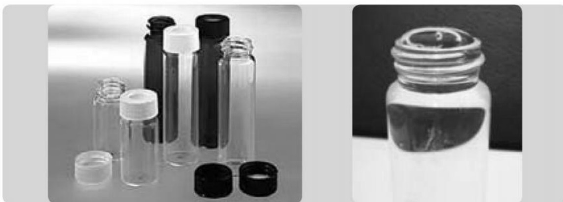
รูปที่ 19 ตัวอย่างขวดเก็บตัวอย่างน้ำเพื่อวิเคราะห์สารอินทรีย์ระเหยและลักษณะน้ำหนุนบนปากขวด
